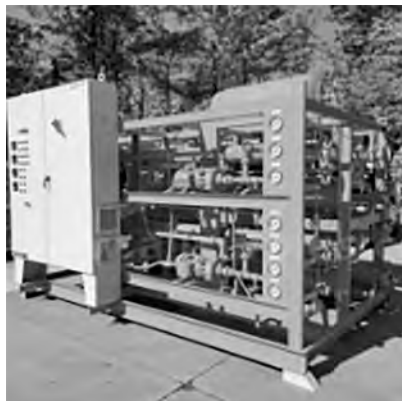
Unidad para control de temperatura en múltiples zonas de las mezcladoras para hule, Budzar Industries LLC año 2024.
