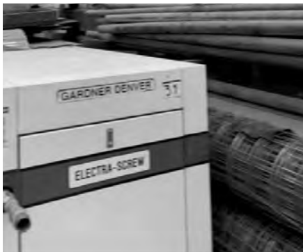
Compresor de aire, Gardner Denver Electra Screw EDE 99M, serie 5104060, con secador Deltech
