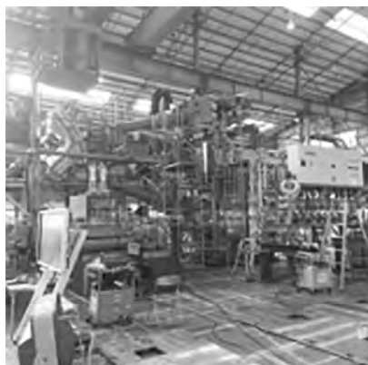
Extrusora triple para hule, Nakata Triplex 200P×200P×200P año 2025.
