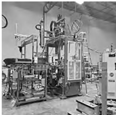
Sistema Kokusai Inc. FDB-6142TB, para balanceo dinámico, automático, para llantas de camiones y autobuses.
